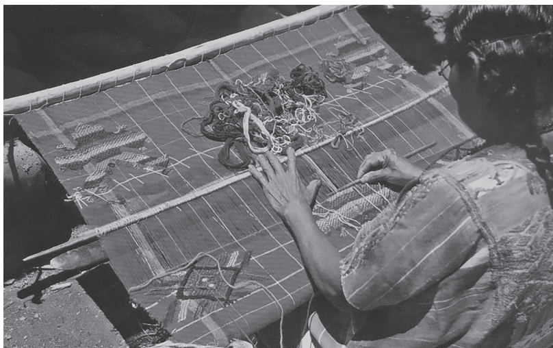
Tejedora chinanteca usa un palo delgado para levantar las urdimbres e insertar las tramas de un motivo de brocado discontinuo en un paño. San Felipe Usila, Oaxaca, 1952.
