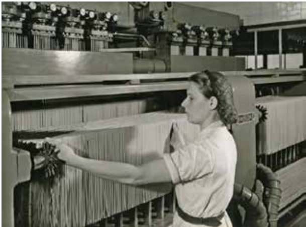
Figura 1. Fotografie | Fabrikation Teigwaren: Automatischer Nudeltrockner
