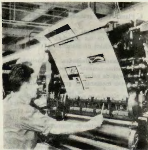
Montaje de la plancha. El operario está apretando los tornillos de ajuste.
