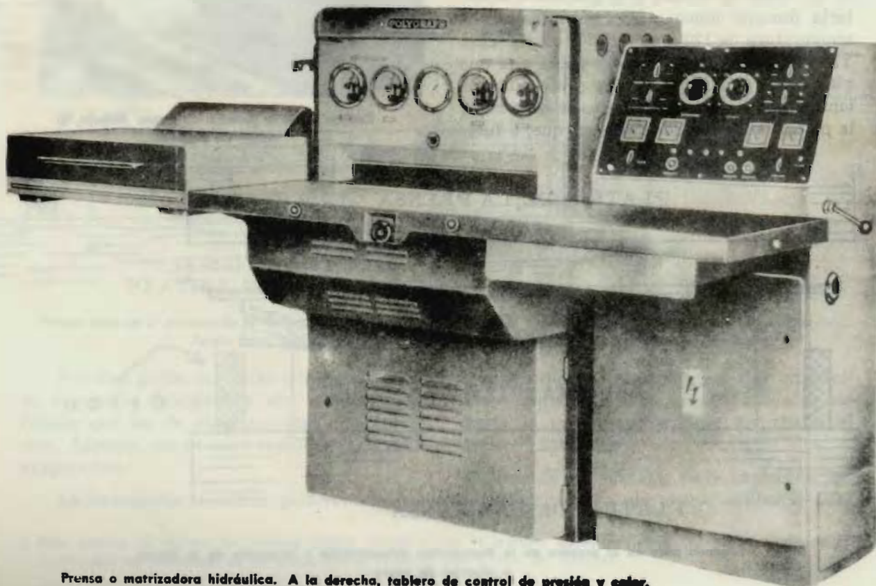
Prensa o matrizadora hidráulica. A la derecha, tablero de control de presión y calor.
