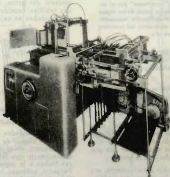
Máquina ponedora de tapas (cubiertas en cartón) y redondeadora de lomos de libros.
