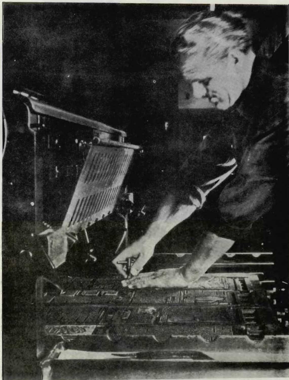
Operario prensista apretando las cuñas para que quedo bien ajustado el material.
