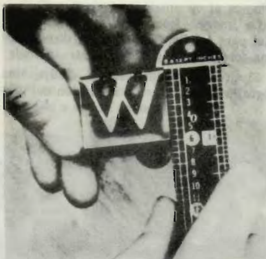
Medida de un tipo con la regla tipométrica o tipómetro. Tiene seis picas.
