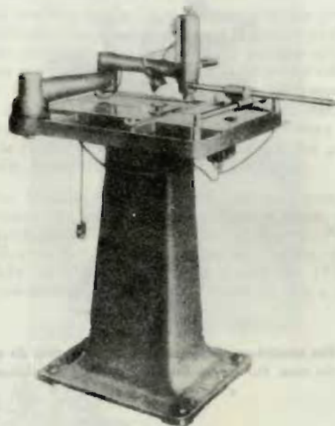
Una fresadora o rebajadora plana, especial para fotograbado.
