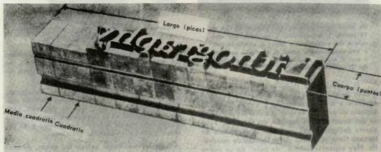
Una línea o renglón tipográfico. Obsérvese el grueso de la L con el de la I, que le sigue. También, la altura de los blancos en comparación con la de los tipos.
