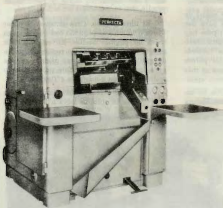
Guillotina que da cortes múltiples, automática. El operario indica o marca los cortes a medida y la máquina los hace unos tras otros.
